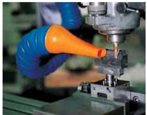
Le nouveau tuyau Loc-Line est conçu pour compléter un système déjà existant d'aspiration à la source de fumée, poussière, vapeur, gases, particules etc. Il est facile à positionner et peut s'adapter à un tube PVC ou métallique.
